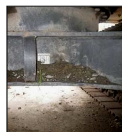
La terre transportée par les engins de chantier peut contenir des graines et des fragments de plantes
