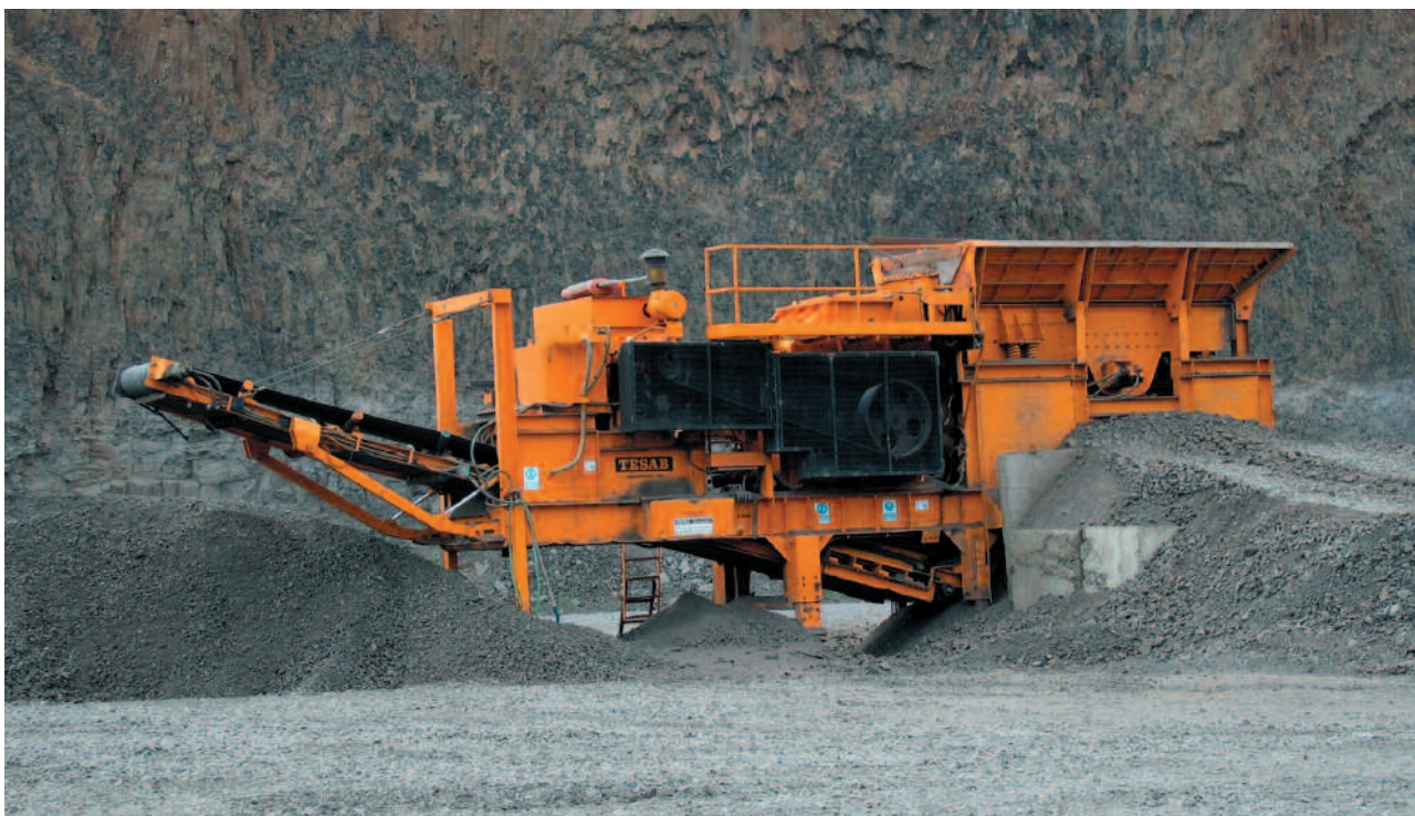
Fabrication de granulats à partir de basalte massif
